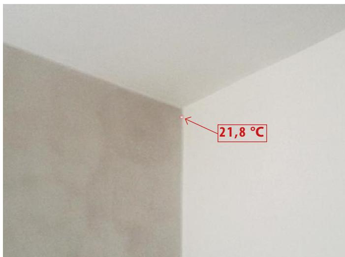
Temperatura rilevata con termometro ad infrarossi nell'“ex ponte termico” dopo l'applicazione di Termofacciata: **21,8 °C con temperatura esterna 5°C.**
